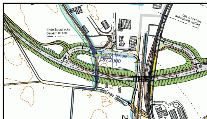
Abbildung 7: Durchlässe im Bereich Stadt Pocking – Bahnstrecke; Südlich der Rott
