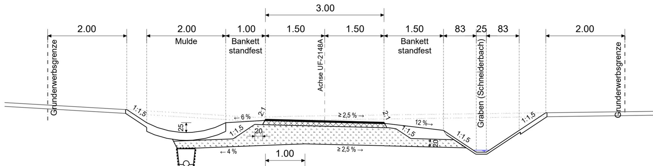
Teilsickerrohr DN 150 Form R2.
