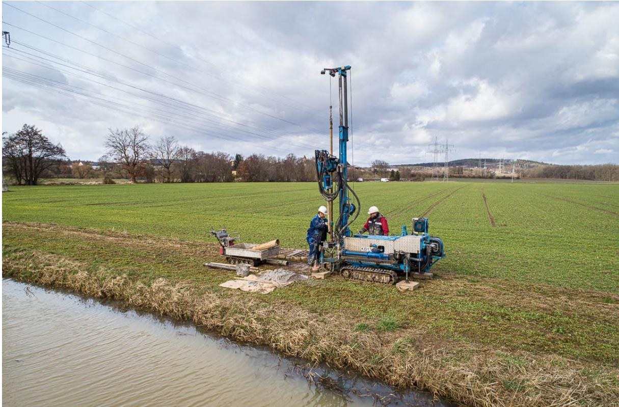
Abbildung 16: Baugrunduntersuchung
