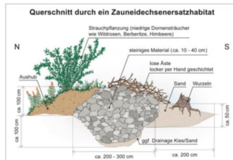
Abb. 4. Prinzipskizze eines Ersatzhabitats mit Überwinterungsmöglichkeit, Totholz und Einstagessubstrat. Grafik: LfU nach einer Vorlage von Irene Wagenzonner, akt. 2020
