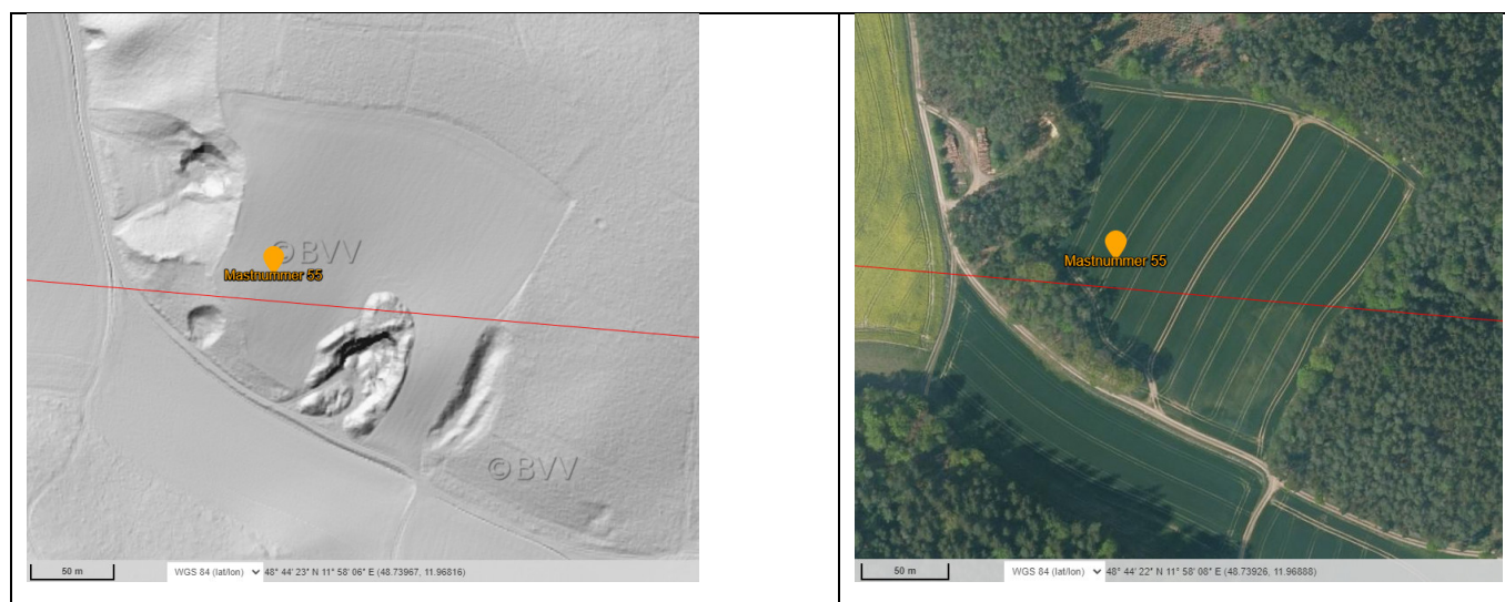
Abbildung 16: Erosionskanten im Geländere relief zu erkennen, Bereich Masten 55, links Geländere relief, rechts Orthofoto aus Bayern Atlas [9]
