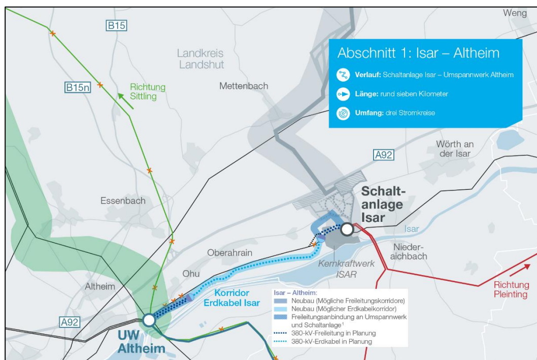
Abbildung 1 Trassenverlauf der 380-kV-Leitung zwischen der Schaltanlage Isar und dem Umspannwerk Altheim [Ten2023a]
