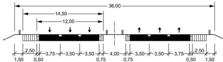
Die Bankettbreiten mit 1,80 m (Bereich Lärmschutzwände 2,50 m) sind entsprechend an die gewählten passiven Schutzeinrichtungen angepasst. Die Bankette werden standfest mit einer Schotterbefestigung ausgebildet.
