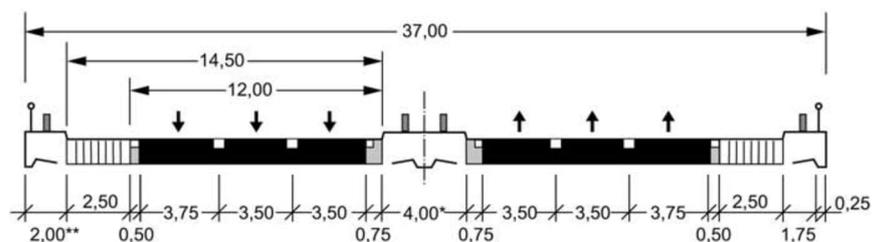
Im Bereich der Bauwerke wird entsprechend des gewählten Querschnittes RQ 36 gemäß RAA für die Strecke ein RQ 36 B gemäß RAA vorgesehen.
